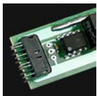
Platine IN optoisoliert (Einspeiseplatine) PCB IN opto-isolated
