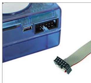
Anschlusskabel für externe Taster (Eingangports) als Zubehör optional erhältlich. Connecting cable for external buttons (input ports) as optional accessory available.
